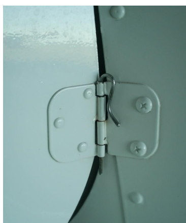
Dispositivo de remoção da porta
