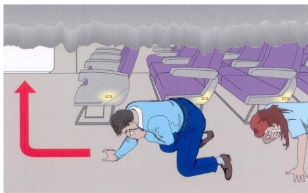
Iluminação de rota de fuga na lateral dos assentos
