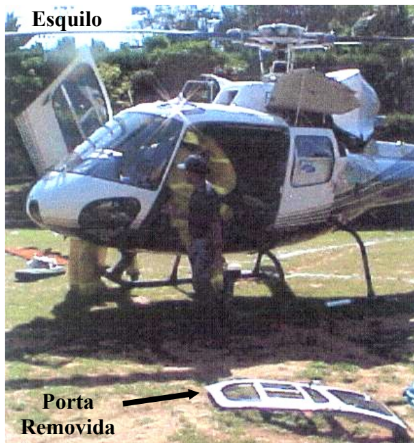
Dispositivo para remoção da porta
