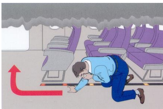
Iluminação de rota de fuga no piso
