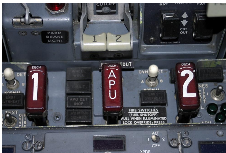
Alarmes de Incêndio nos Motores e Acionadores do Sistema Fixo de Extinção.
