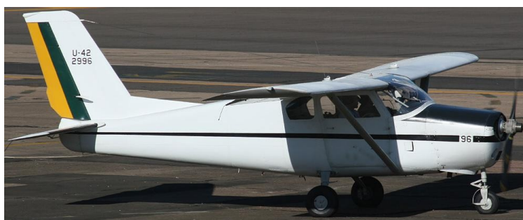
Regente U-42 FAB com protótipo de motor flex
